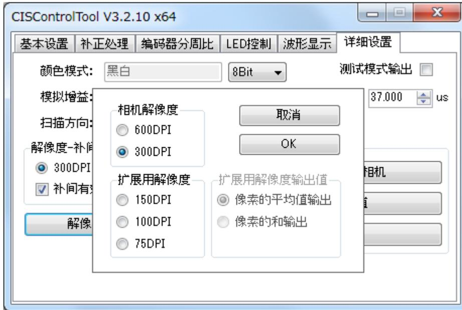
按一下“详细设置”选项卡的“解像度设置”按钮，将显示设置面板。
