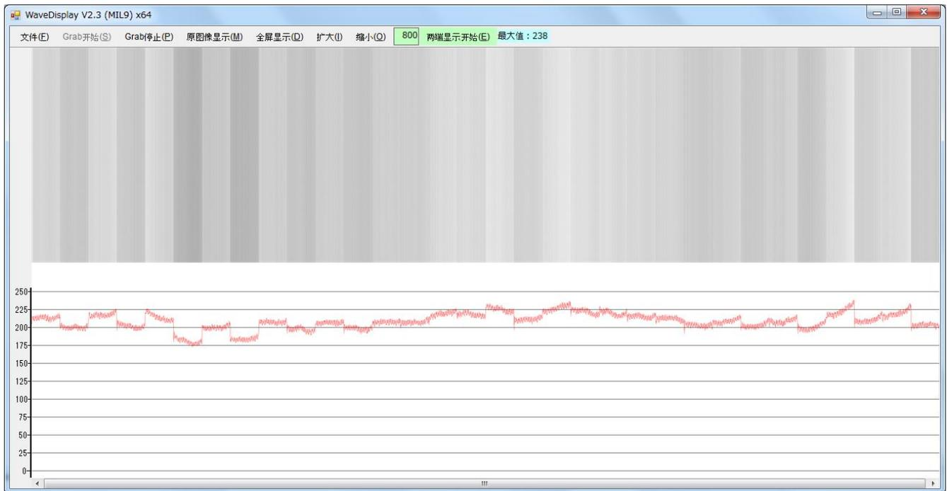
显示主扫描方向的图像。线阵相机整体的像素输出可通过移动 Window 下方的光标进行确认。请观察本波形，调节光强度后，执行上述明暗校正处理。在下面进行“5.线阵相机的安装”时，使用附有图案的被摄体，在本画面上观察移动光标时图像的模糊程度，调节倾斜程度等，以调节相机整体的焦点位置。
