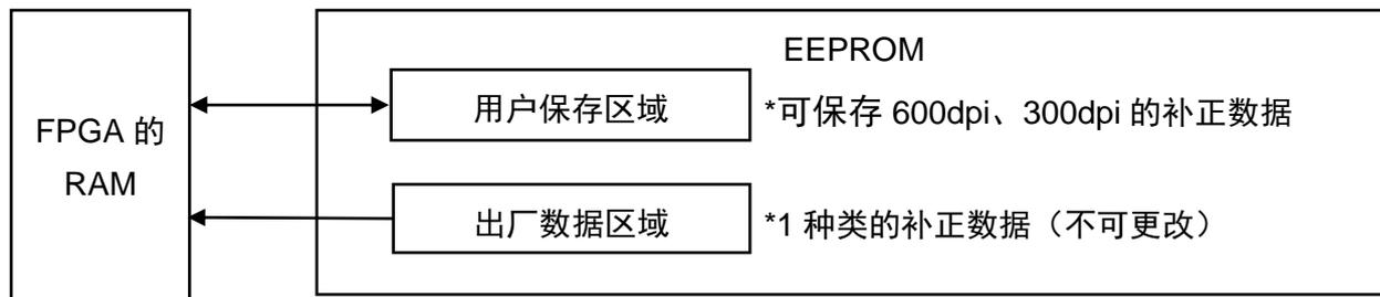
**FPGA 的 RAM:** 电源断开时，所有数据将消失。所有的相机控制通过 FPGA 的 RAM 进行。
