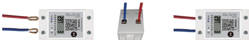
电源线插入压线端子后拧紧
